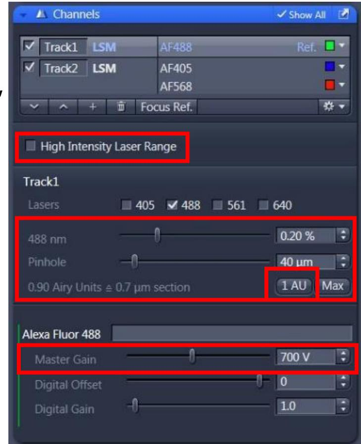
注意：调节图片拍摄参数使图片的荧光强度落在动态范围内，否则图片将过曝，可将预览图片下方的 **Dimensions** 下  **Range Indicator** 打勾，此时图片过曝的地方将以红色指示，一般情况下建议有一两点过曝即可）
