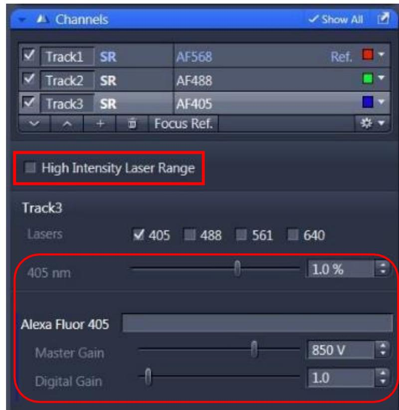
注意：调节图片拍摄参数使图片的荧光强度落在动态范围内，否则图片将过曝，Airyscan模式不用要求占满整个Display的动态范围。
